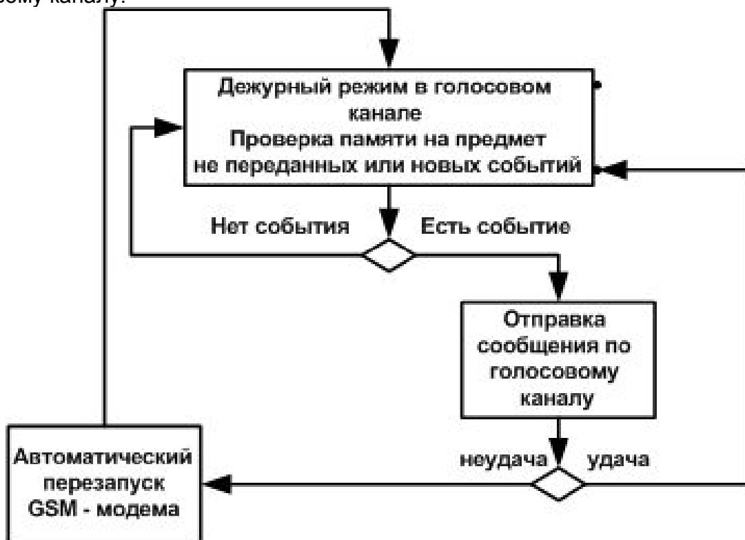
Рисунок 1. Алгоритм отправки сообщений и изображений ПВКТ «Лунь-Видео». Вариант Б. Если ПВКТ «Лунь-Видео» сконфигурирован для передачи сообщений по голосовому каналу:
