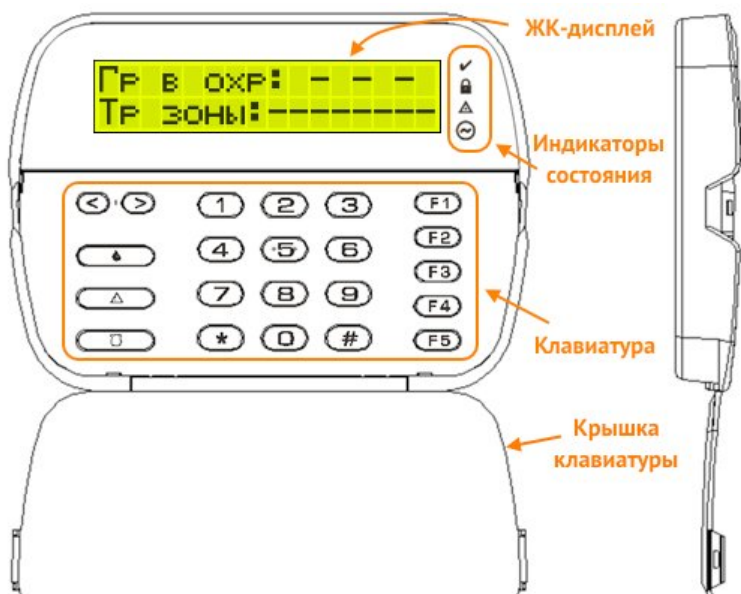
Рисунок 8. Внешний вид УИУ «Линд-10» с открытой крышкой
