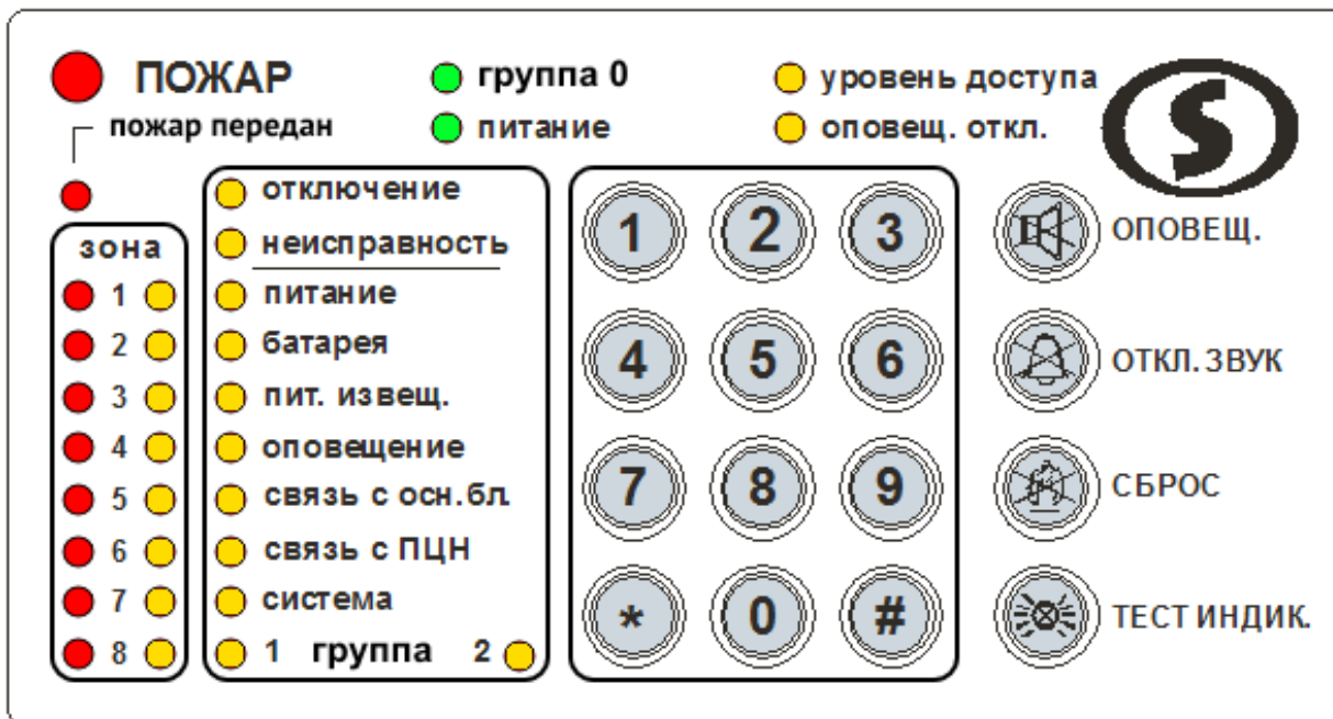
Рисунок 5. Внешний вид лицевой панели УИУ «Линд-Т»
