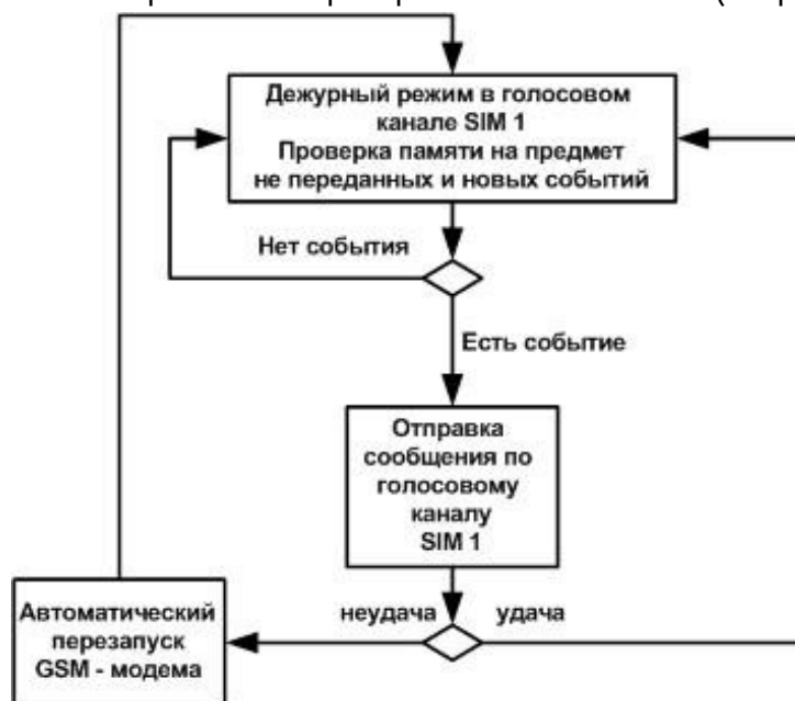
Рисунок 4. Использование канала связи Voice для одной SIM-карты
