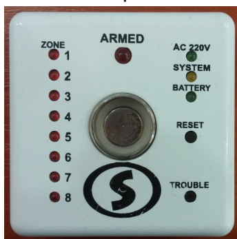
Рисунок 10. Общий вид УИУ «Линд-8»
