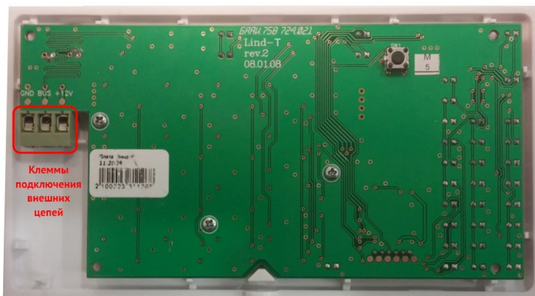
Рисунок 6. Плата УИУ (с обратной стороны)
