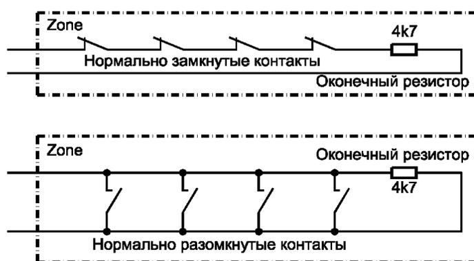
Рисунок 3. Схема подключения УСО "Луны-9С мод.2"
