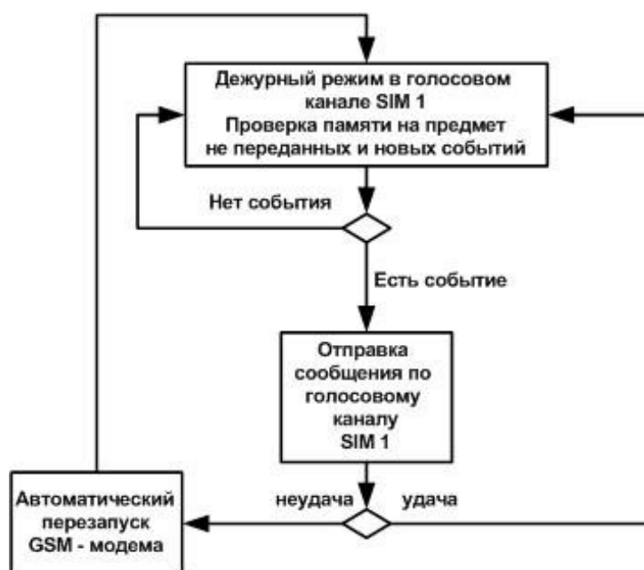
Рисунок 4. Использование канала связи Voice для одной SIM-карты
