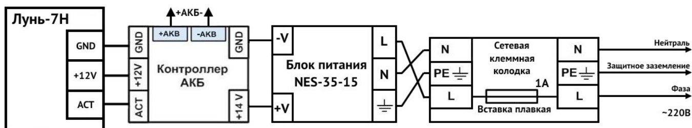
Рисунок 7. Подключение электропитания «Лунь-7Н»
