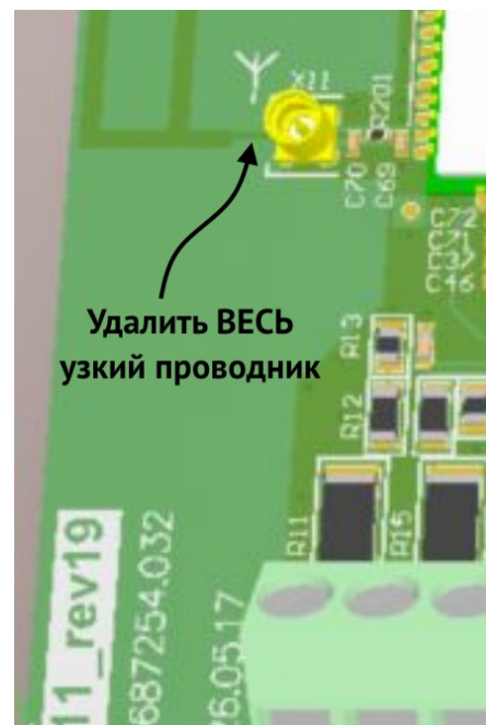
Рисунок 6. Подготовка платы ревизии 19 для подключения внешней антенны
