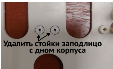
Рисунок 28. Подготовка места для адаптера «L25_Crow_rev3»
