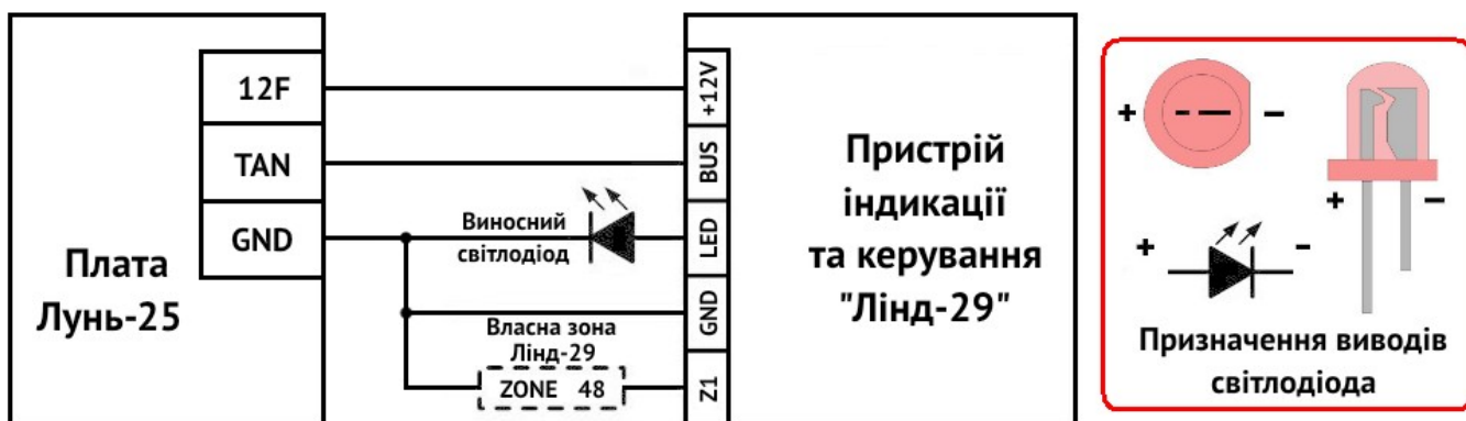
Малюнок 6. Схема під'єднання до ППК "Лунь-25"
