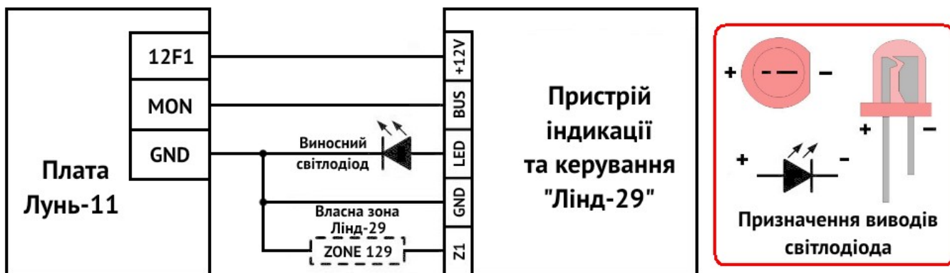
Малюнок 5. Схема під'єднання до ППК "Лунь-11"
