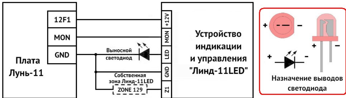
Рисунок 7. Схема подключения УИУ к ППКОП серии «Лунь-11»
