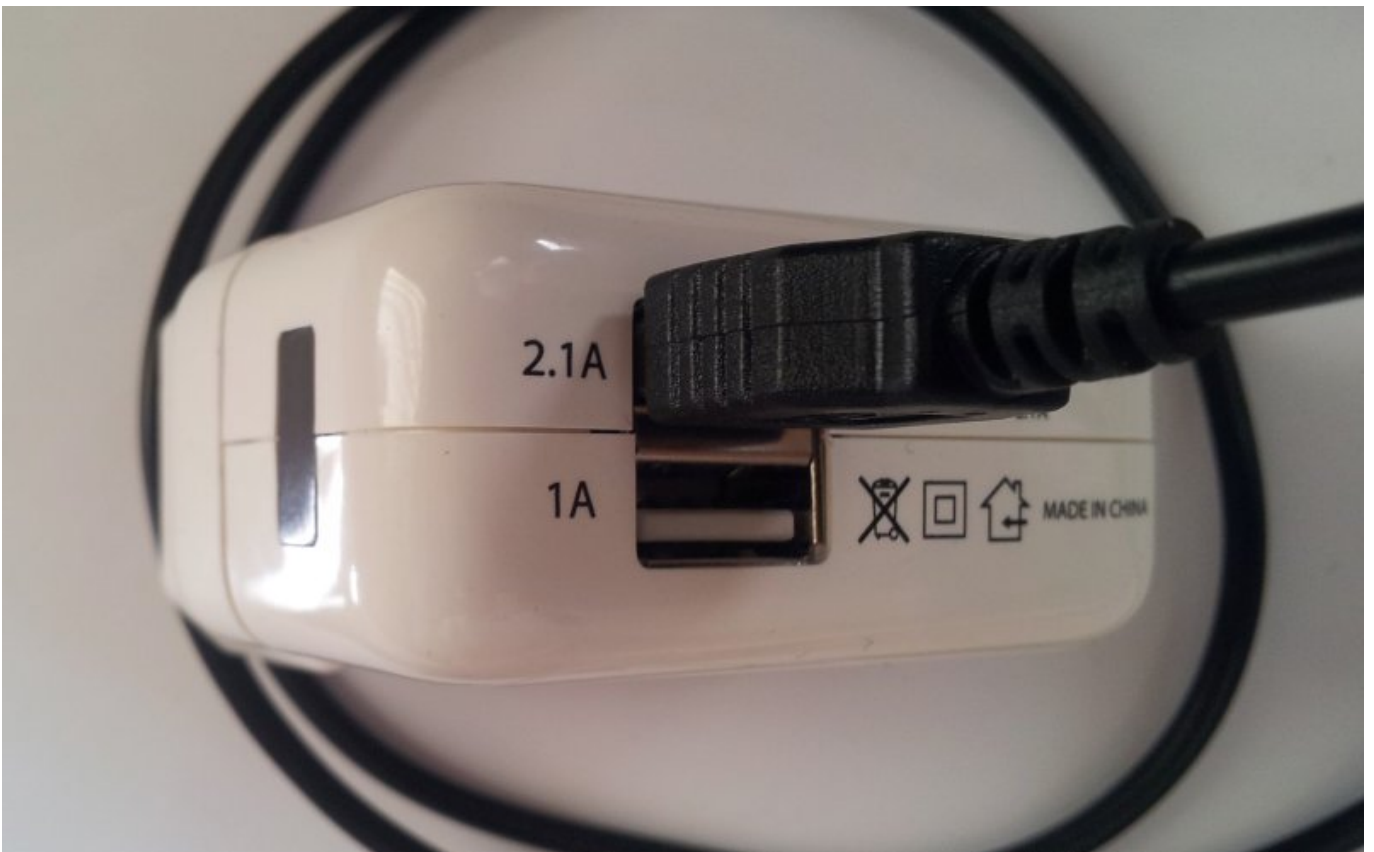
Малюнок 2. Під'єднання кабелю до зарядного пристрою
