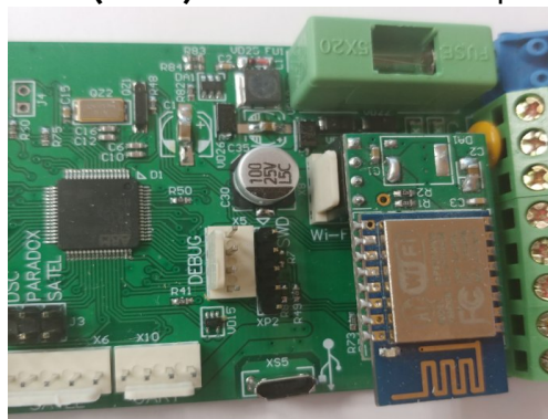
Рисунок 7. Установка WiFi модуля
