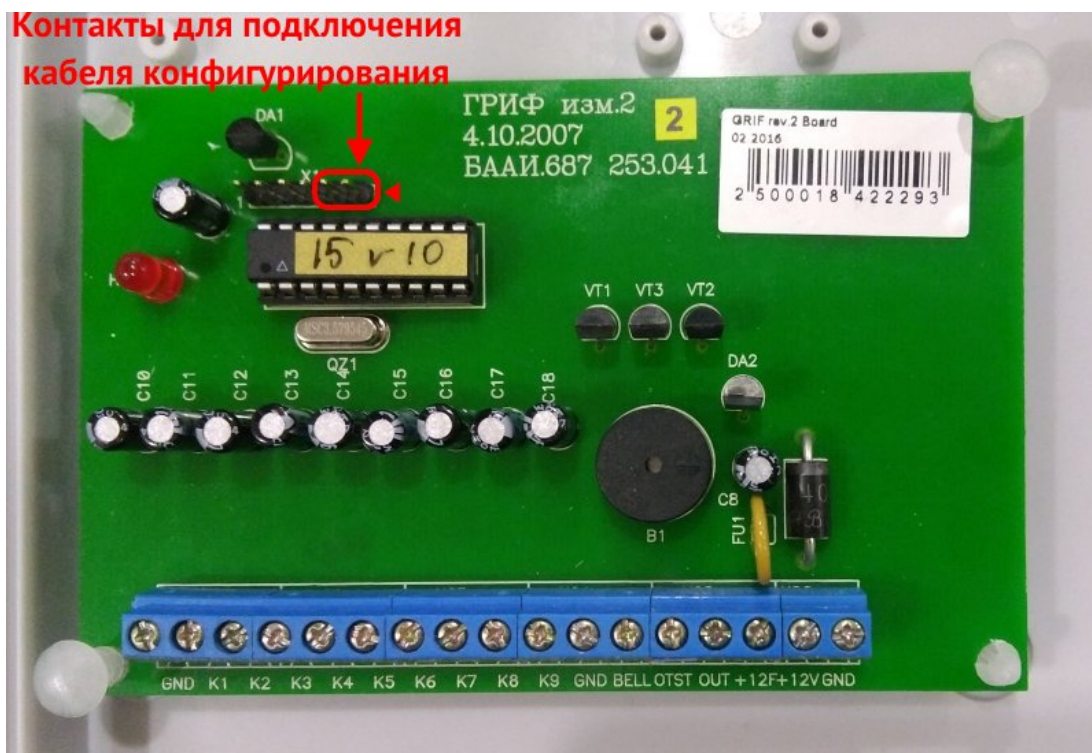
Рисунок 2. Расположение клемм на плате устройства
