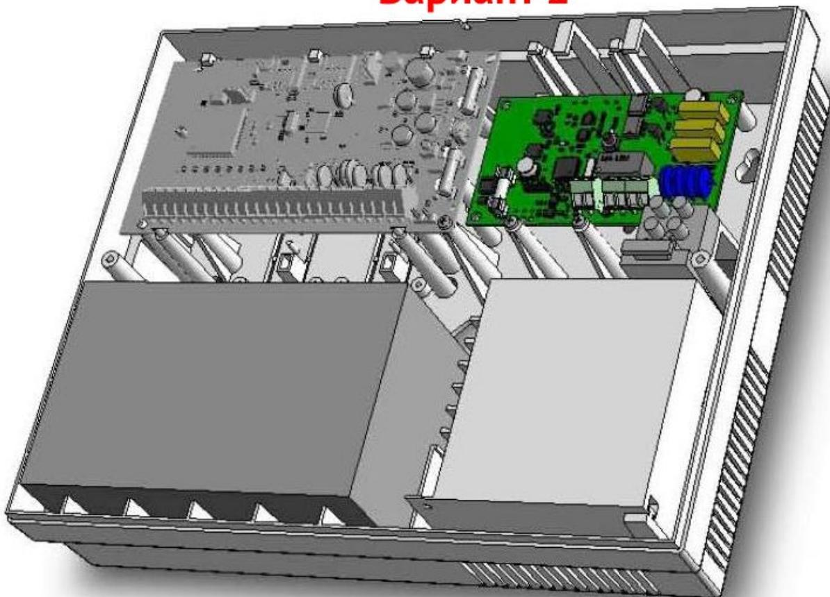
Рисунок 5. Варианты установки ТК в корпусе Б004
