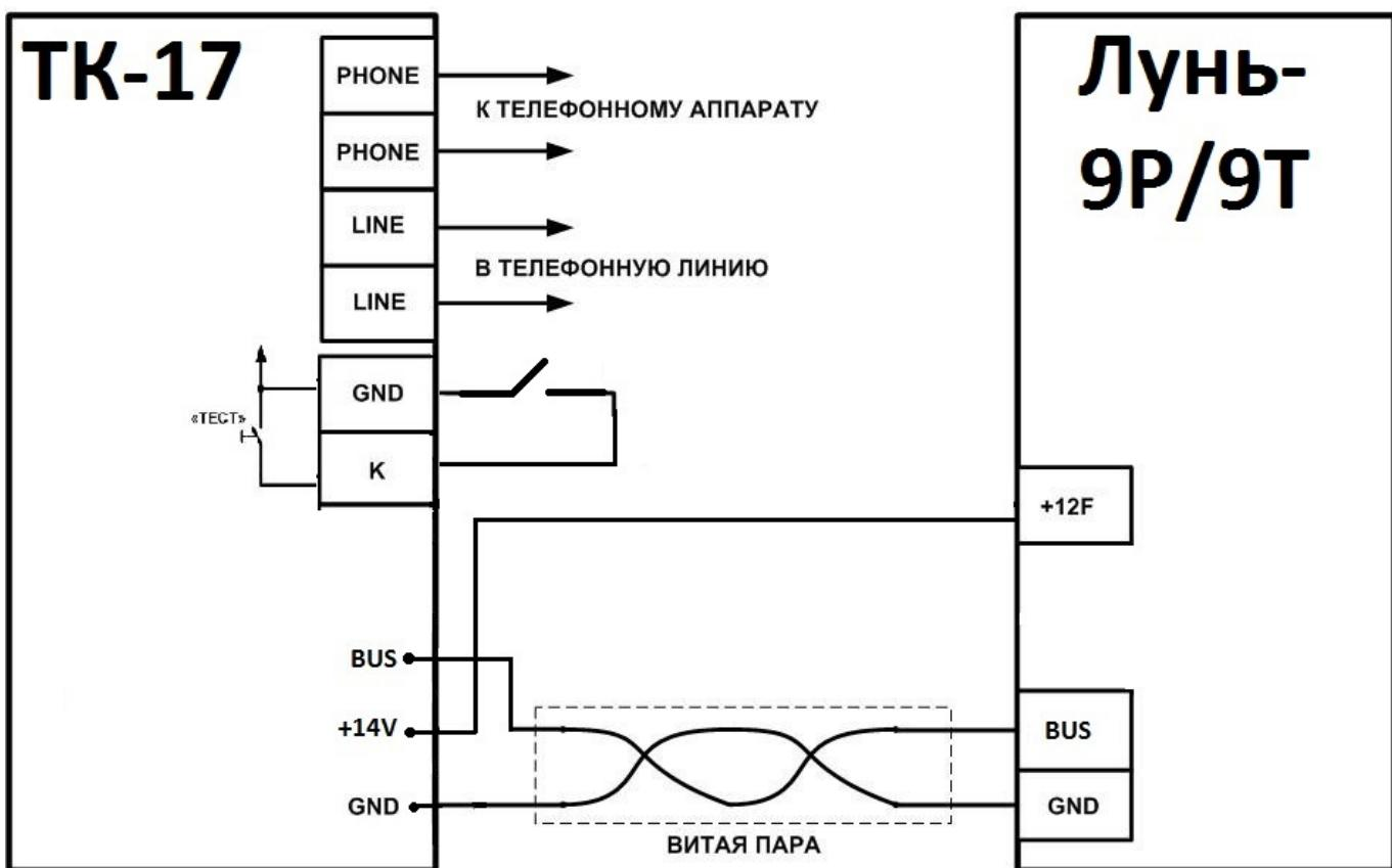
Рисунок 3. Схема подключения к ППК «Лунь-9Р/9Т»
