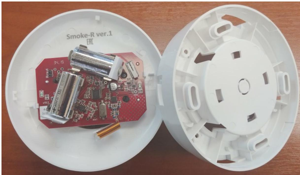
Рисунок 1. Извещатель со снятым основанием
