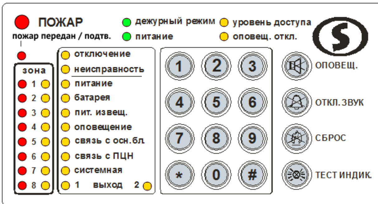
Рисунок 7. Внешний вид лицевой панели УИУ "Линд-Р"
