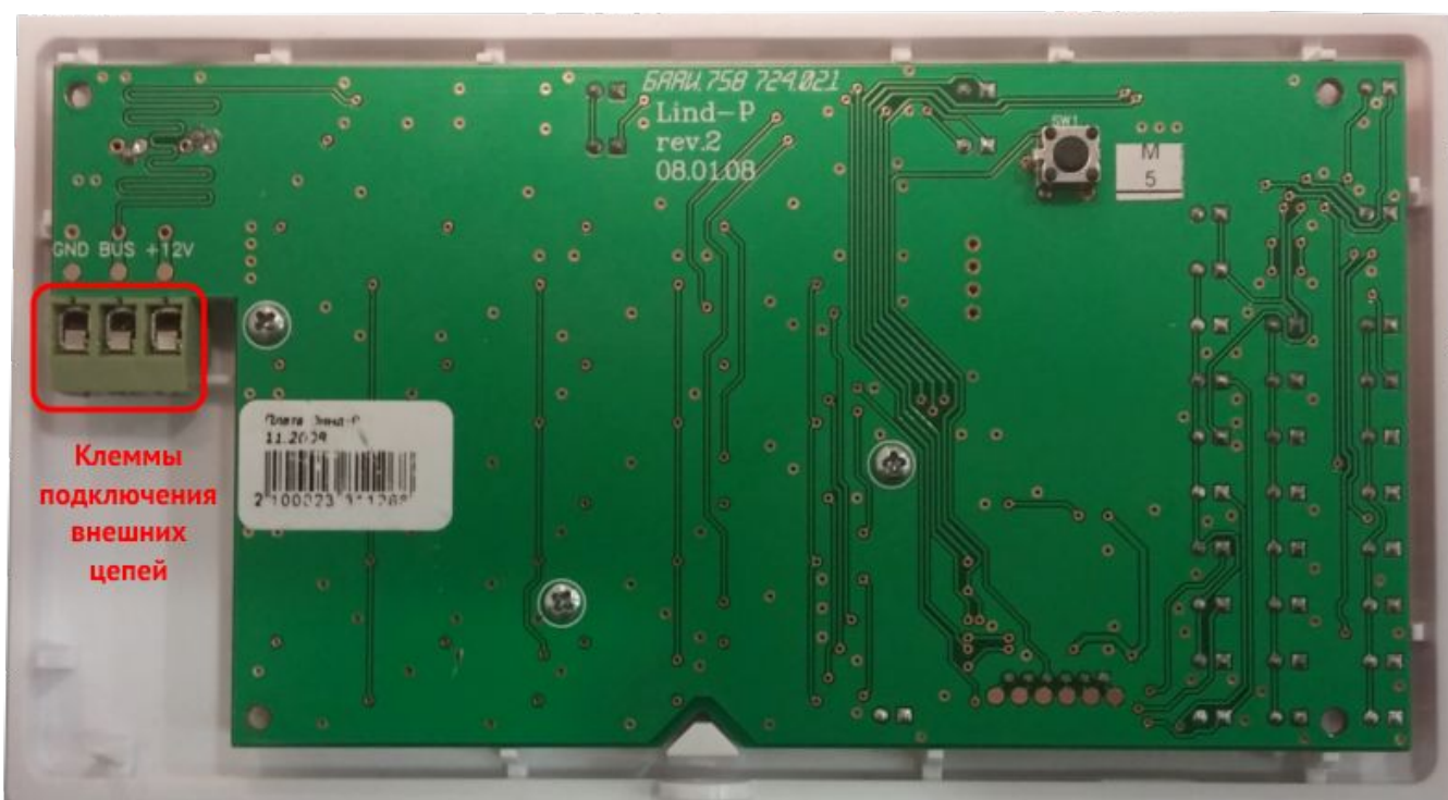
Рисунок 8. Плата УИУ (с обратной стороны)
