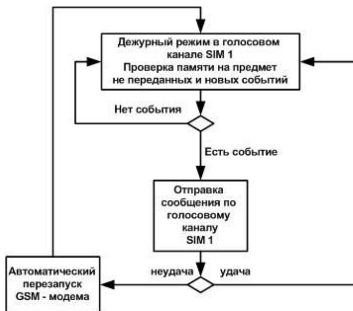
Рисунок 6. Использование голосового канала связи для одной SIM-карты
