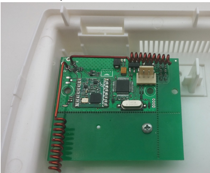
Малюнок 13. Радіоприймач Ajax «uart Bridge» в корпусі ППКОП (без модуля WiFi)
