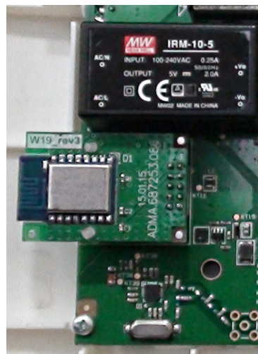
Малюнок 6. Встановлений модуль WiFi
