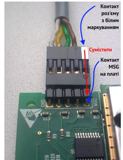
Малюнок 12. Під'єднання кабелю радіоприймача Visonic
