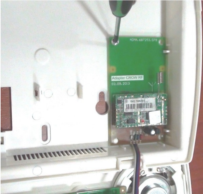
Малюнок 8. Встановлення приймача «CrowRF»
