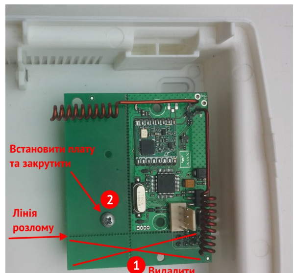
Малюнок 14. Радіоприймач Ajax «uart Bridge» в корпусі ППКОП (з модулем WiFi)
