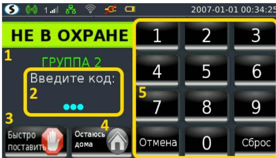
Рисунок 12. Экран ввода кода постановки
