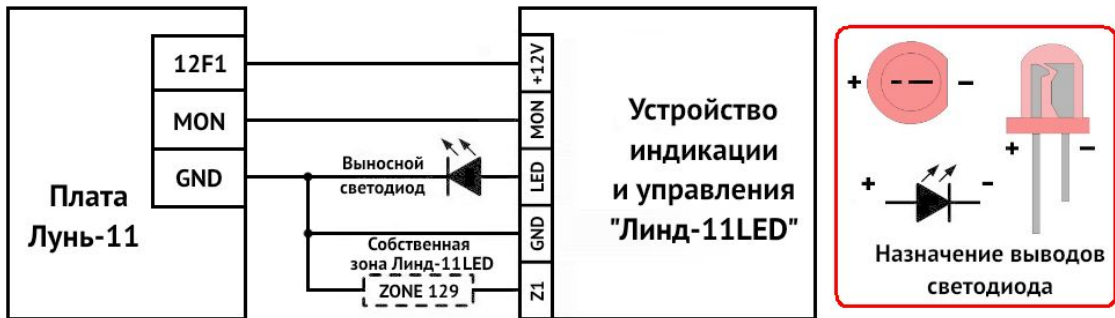
Рисунок 7. Схема подключения УИУ к ППКОП серии «Лунь-11»
