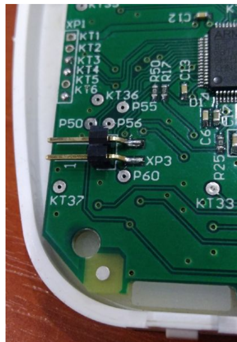
Рисунок 6. Разъем для обновления управляющего ПО
