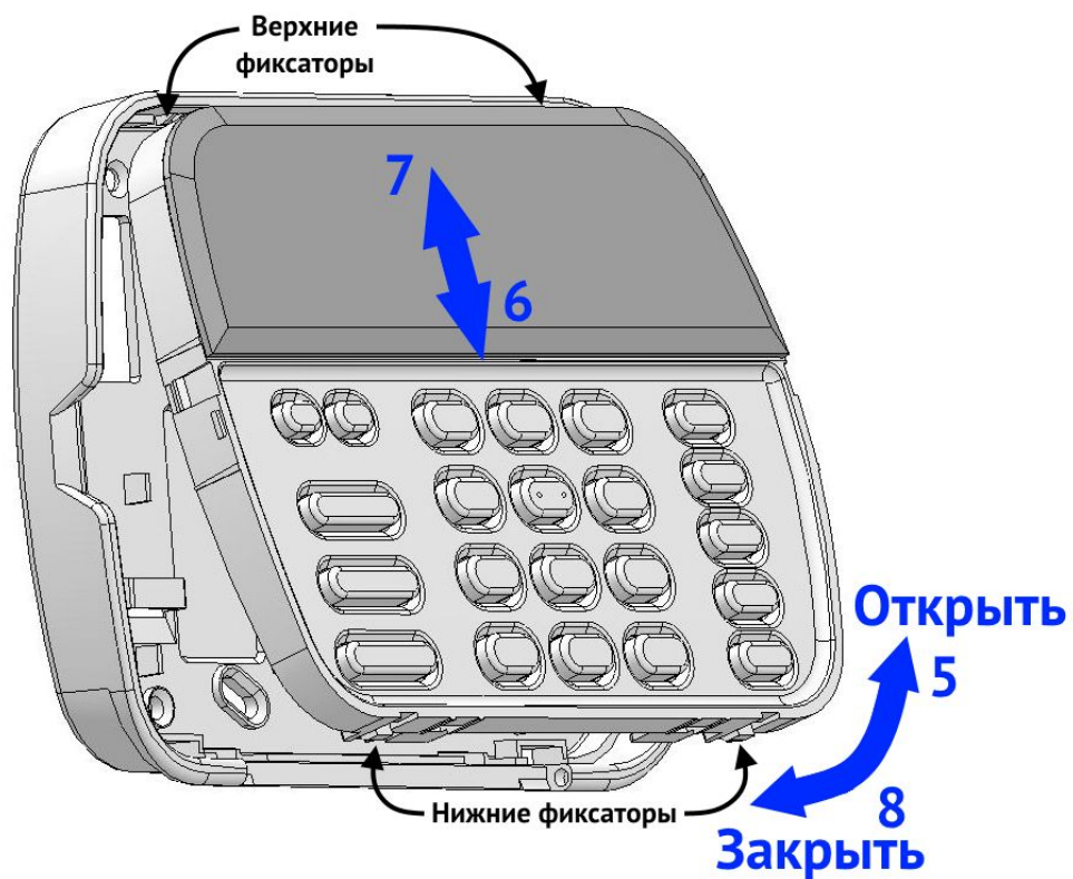
Рисунок 4. Извлечение клавиатуры
