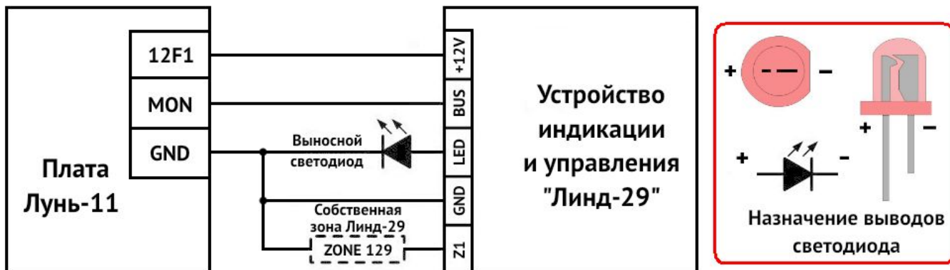
Рисунок 5. Схема подключения УИУ к ППКОП «Лунь-11»
