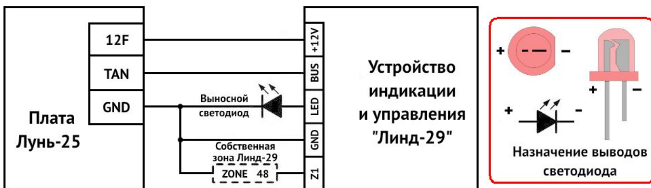
Рисунок 6. Схема подключения к ППКОП «Лунь-25»
