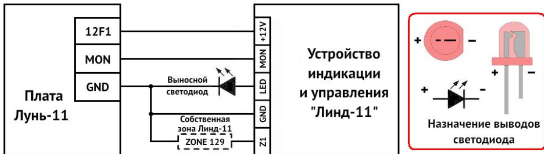
Рисунок 12. Схема подключения УИУ «Линд-11» к ППКОП
