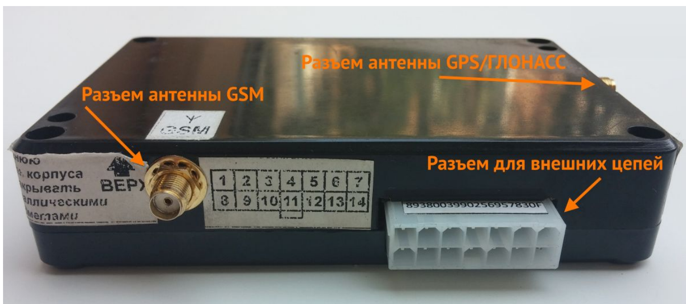
Рисунок 1. Внешний вид устройства «Алет-9»
