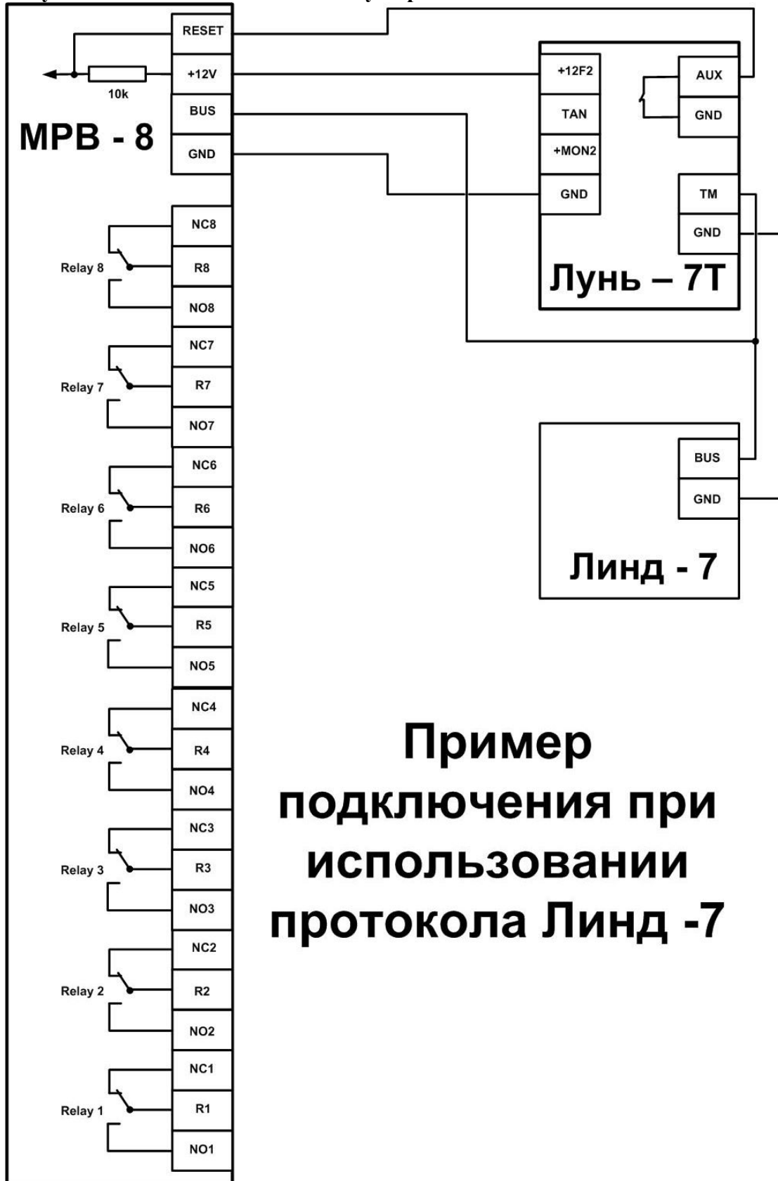
Рисунок 9 Схема подключения модуля релейных выходов МРВ-8
