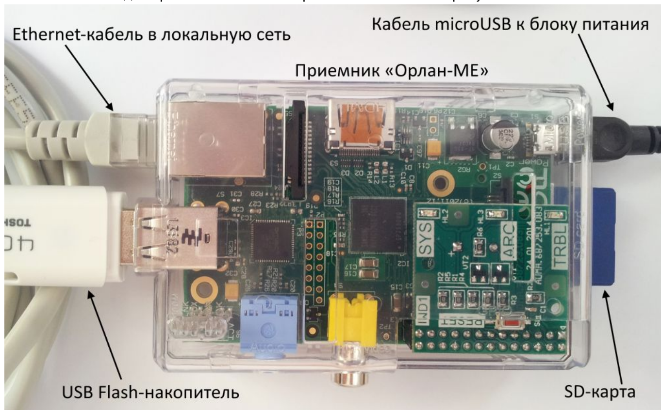
Рисунок 1. Внешний вид собранного комплекта приемника «Орлан-МЕ»
