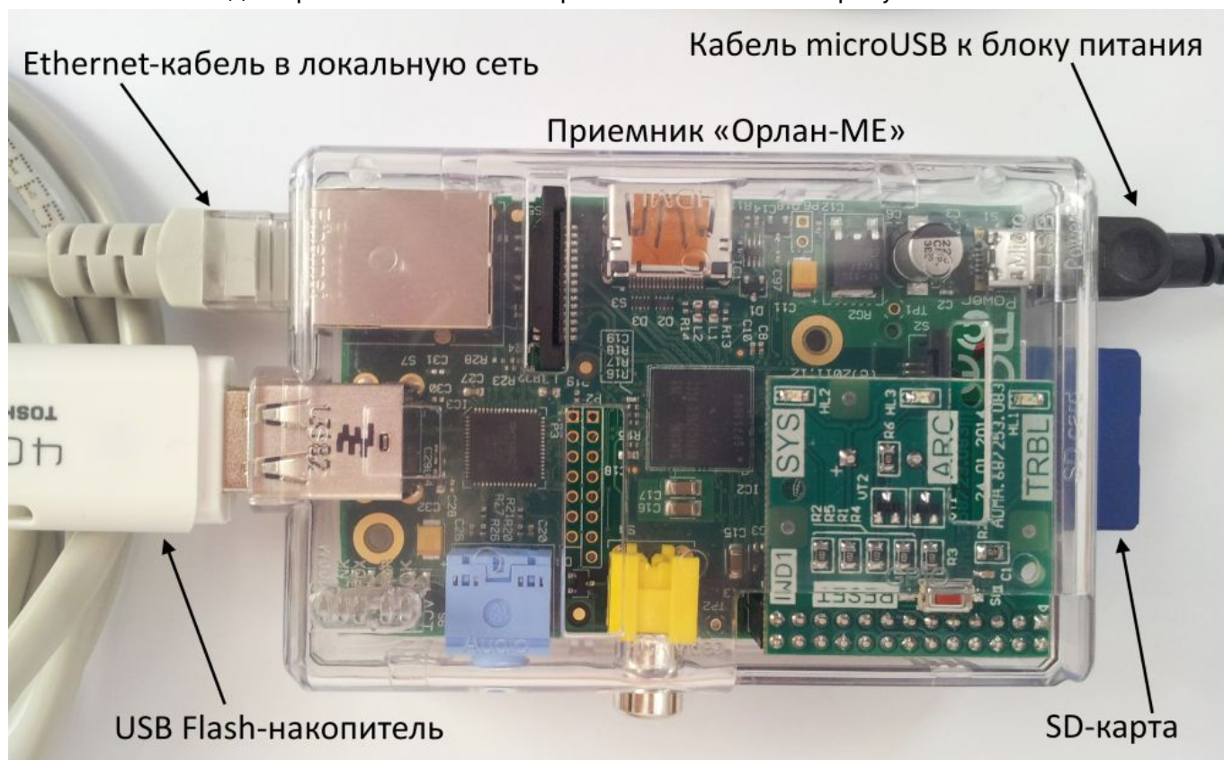
Рисунок 1. Внешний вид собранного комплекта приемника «Орлан-МЕ»
